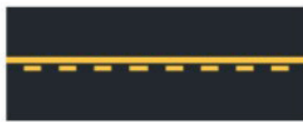
LÍNEA DE SEPARACIÓN DE SENTIDO DE CIRCULACIÓN OPUESTA (No debe ser traspasada ni circular sobre ella)
